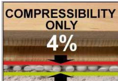
Tuplex conserva la propria forma sotto carico. La prova è stata eseguita sottoponendo il materiale Tuplex ad un carico corrispondente a 600 Kg/m<sup>2</sup>. Nel corso dei 7 giorni di prova, il campione in Tuplex ha perso solo il 4% del proprio spessore. Le schiume comuni hanno perso il 56% del proprio spessore nello stesso test.
