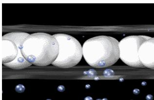
**BARRIERA CONTRO L'UMIDITA':** Tuplex è un sandwich costituito, tra gli altri elementi, da due strati di polietilene, questi creano una barriera al vapore notevolmente efficace, quindi il suo utilizzo come sottopavimento non richiede una barriera al vapore separata.
